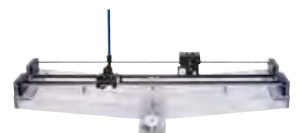
槓桿平衡控制擺系統 (需要 2 套平衡控制系統 + 2 套線性擺模組)
